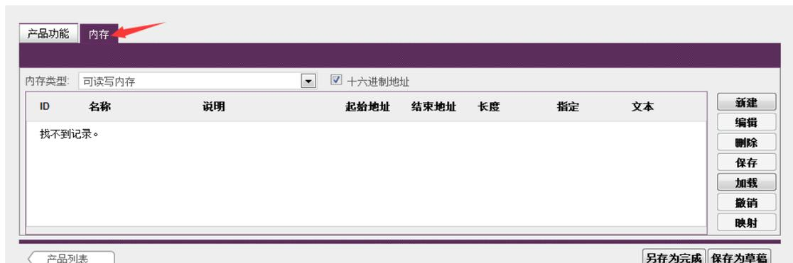
如果要在加密锁中存数据，可以在产品定义界面中的内存页面操作。此数据仅限加密锁函数调用方式使用，外壳加密无法操作该部分数据。内存的容量大小与加密锁硬件型号有关，具体请参阅各产品介绍。
